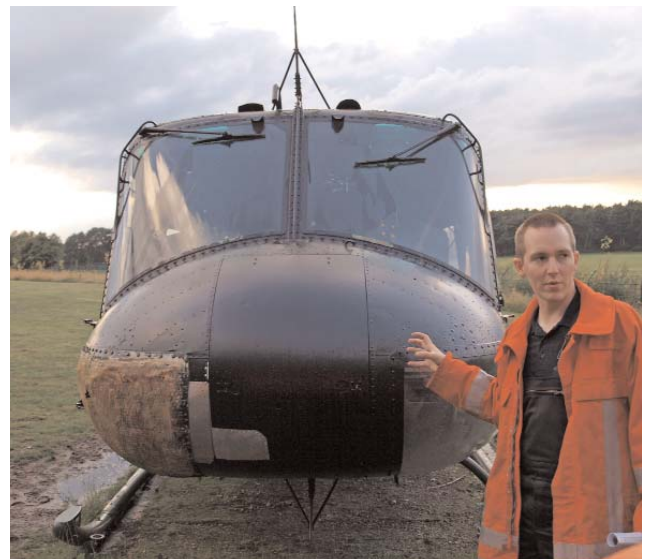
Am Dummy wird die Trennung von Batterie und Bordnetz besprochen
