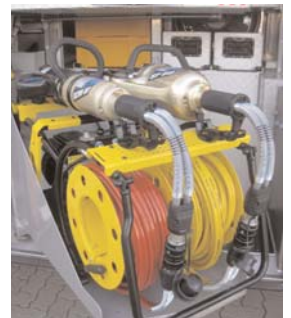
Von Weber: der Spreizer SP 60 und die z.Zt. modernste Schere RS 200-107.
