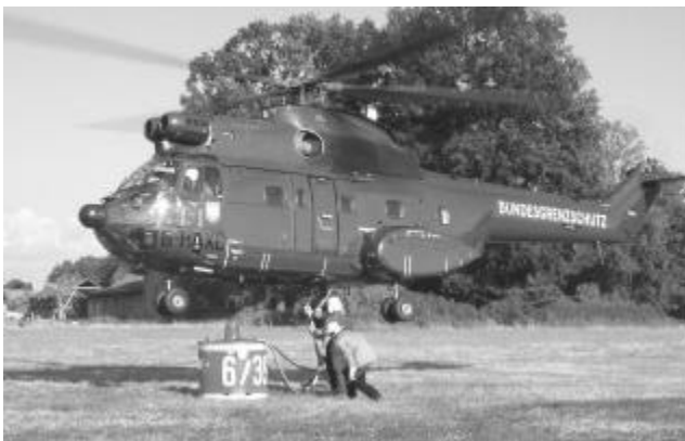
Einhängen des Außenlastbehälters unter dem schwebenden Hubschrauber
