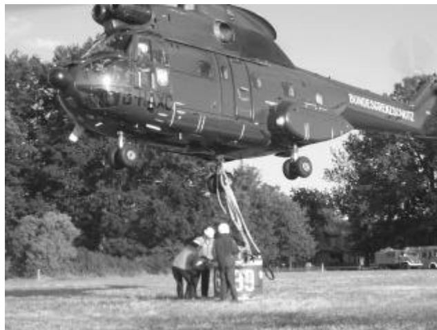
Befüllen des Außenlastbehälters unter dem schwebenden Hubschrauber
