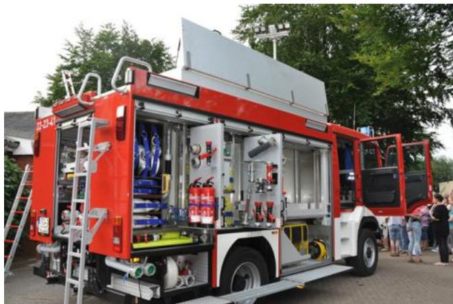
Schaltgetriebe und Dachwasserwerfer, 15,5 Tonnen schwer und 290 PS stark. Das besondere Markenzeichen jedoch ist der 3.800 Liter fassende Wassertank, der größte im gesamten Landkreis.
