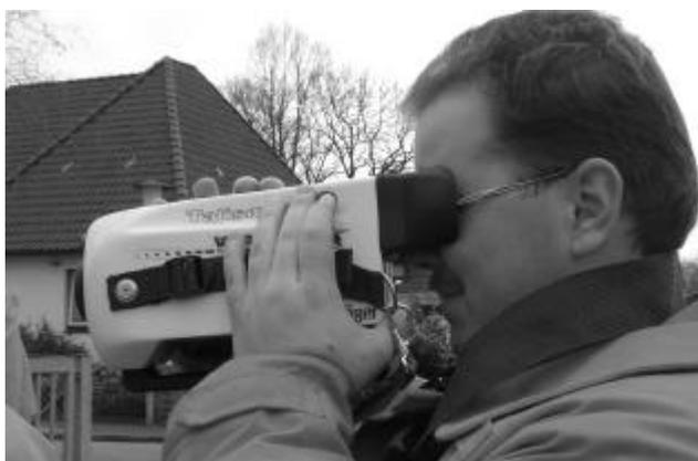
Die Wärmebildkamera ist ziemlich einfach und unkompliziert zu bedienen. Dem Feuerwehrmann stellt sich die Flamme als heller Punkt im Bild der Kamera dar.
