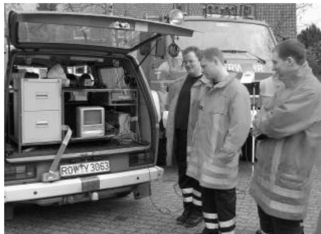
Bei der Ortsfeuerwehr Bremervörde können die Bilder von der Kamera, die der Angriffstrupp z.B. bei einem Innenangriff mitnimmt, direkt auf einen Monitor im ELW übertragen werden. Mit Hilfe der Wärmebildkamera lässt sich ein Brandherd schneller lokalisieren und bekämpfen. Fotos: Frank Bartmann
